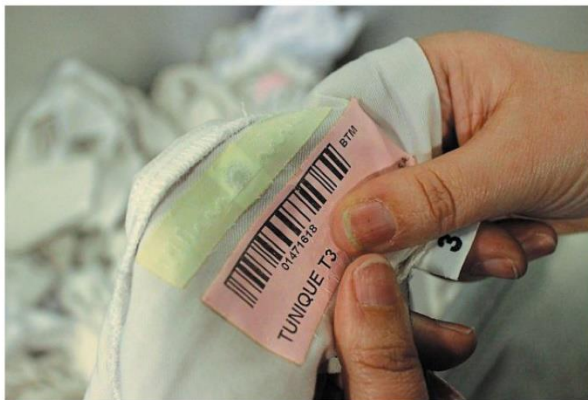
Beaupréau, rue Louis-Lumière, jeudi 10 août. Les vêtements de travail sont pucés pour être localisables dans la blanchisserie. Et être traités par client, taille...
