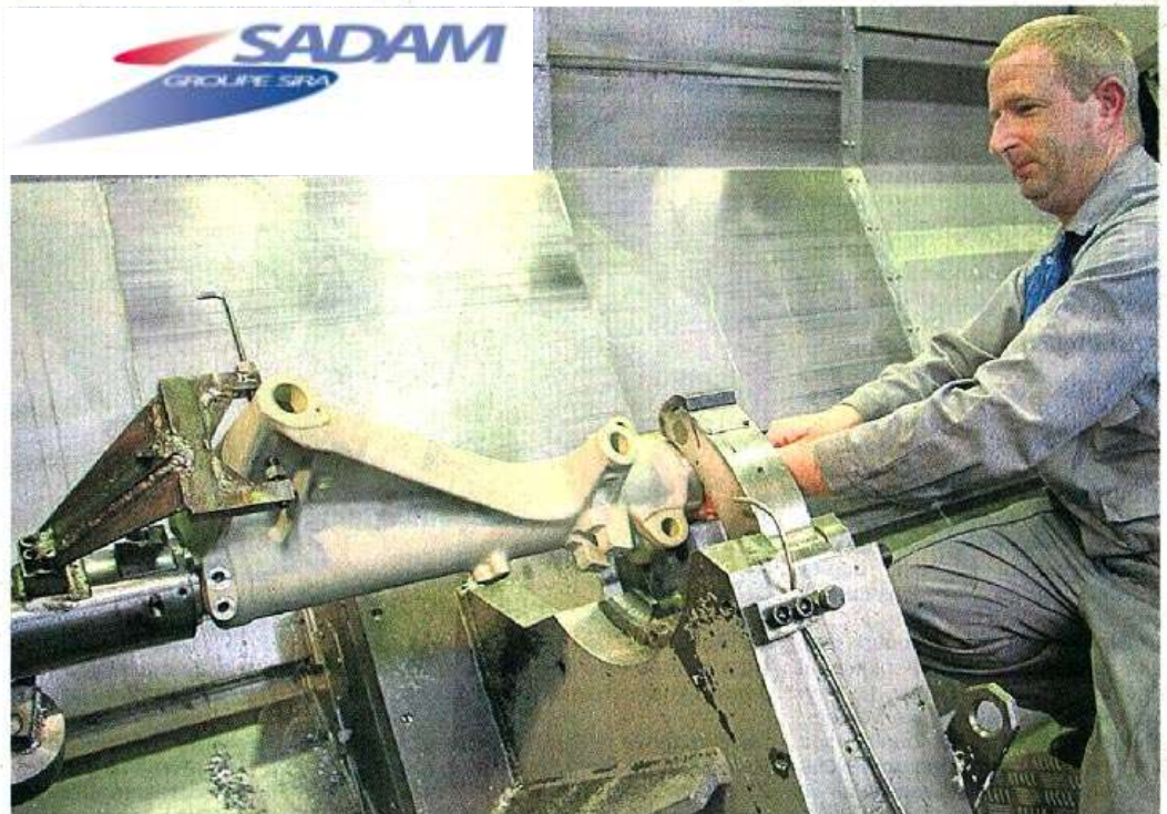
Mazières-en-Mauges, société Sadam, hier. Cette pièce du train d'atterrissage d'un Airbus A 320 est en aluminium. Les Chinois ont raflé le contrat. Sadam que dirige Philippe Veistroffer s'oriente vers des pièces encore plus complexes à réaliser, notamment des éléments en composite.
