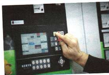
MICs KERYs : produit développé par le service R & D SOREEL permettant le contrôle des groupes électrogènes.
