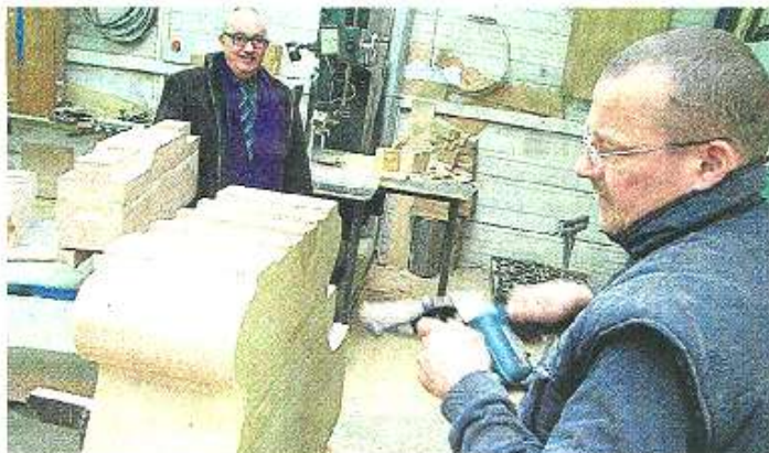
Trémontines, Bodet, hier. Les menuisiers terminent la fabrication des « moutons », ces pièces de chêne sur lesquelles seront fixées les cloches.
