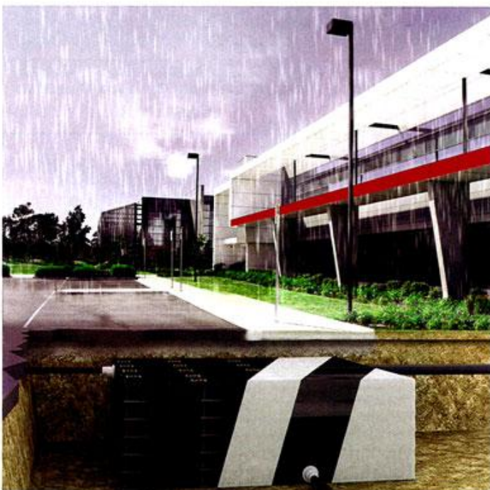
Waterloc permet d'écarter les afflux d'eaux pluviales en assurant un stockage temporaire de l'excédent de l'eau de ruissellement, puis une restitution en milieu naturel par infiltration dans le sol.
